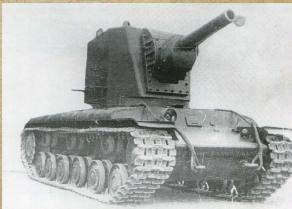
★ Танк KB № У-3. Кировский завод. Февраль 1940 года. На орудии смонтирована крышка для защиты от попадания внутрь ствола пуль и осколков. Обращают на себя внимание и крылья авиационного типа.
