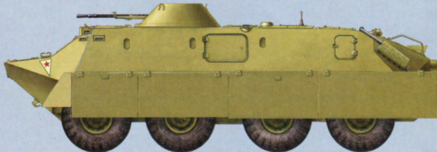
БТР-60ПБ с дополнительной бронезащитой, модернизированный курдскими ополченцами, воюющими на стороне правительства. Сирия. Лето 2013 года.
